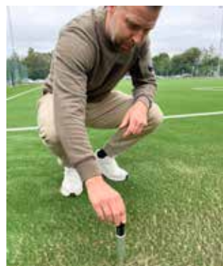
Pierre kontrollerar hur djup sanden är.
